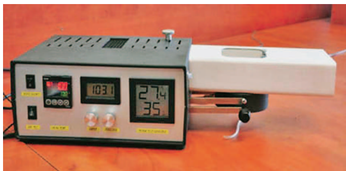
Sl.7 Uređaja za nedestruktivno mjerenje otpora prolazu topline i propusnosti vodene pare i otpora prolazu vode, Permetest
