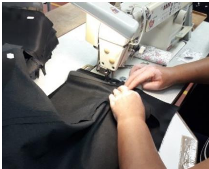
S1.3 Šivanje podstave na duljinu rukava sa zatvorenim rasporkom [8]
