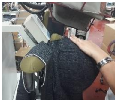
Sl.28 Lijepljenje ramenog ojačanja na preši [8]
