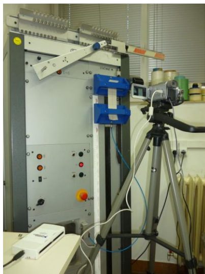
Sl.6 Fotografski prikaz mjerenja uzdužne deformacije uzorka tkanine do prekida
