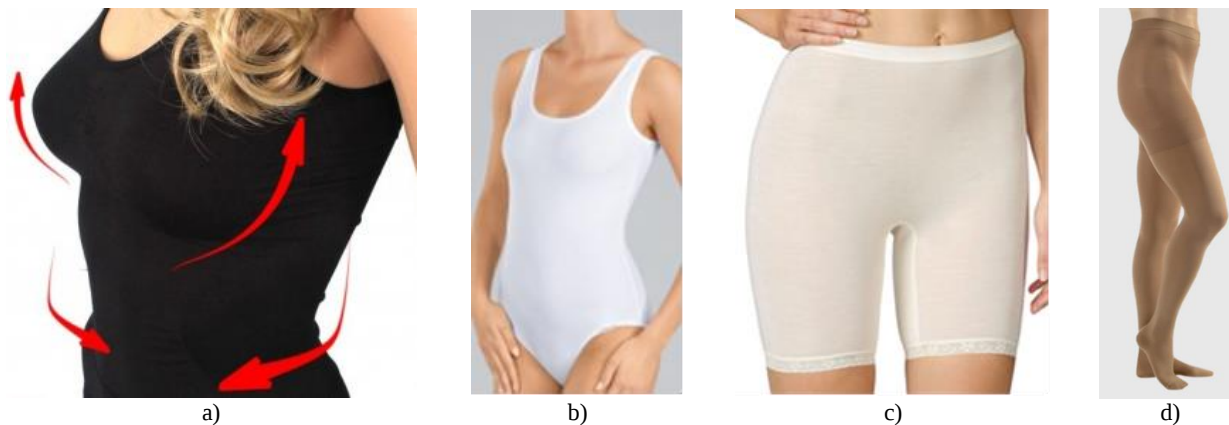
Sl.4 Odjevni predmeti izrađeni od elastičnog pletiva: a) ženska potkošulja s gaćicama (bodi) izrađena sa 97 % PA i 3 % elastana, b) ženska potkošulja s gaćicama izrađena s pamučnom pređom finoće 17 tex i elastanskom pređom finoće 33 dtex, udio pamuka 95 % i elastana 5 %, c) ženske zimske gaće izrađene s vunenom pređom finoće 14 tex (veoma velika finoća vlakana - 14 \mu m) i elastanskom pređom finoće 44 dtex, udio vune 90 % i elastana 10 %, d) ženske preventivske čarape s gaćicama izrađene s PA multifilamentnom pređom finoće 60 dtex i elastanskom jednostruko omotanom pređom finoće 56/33/17 dtex
